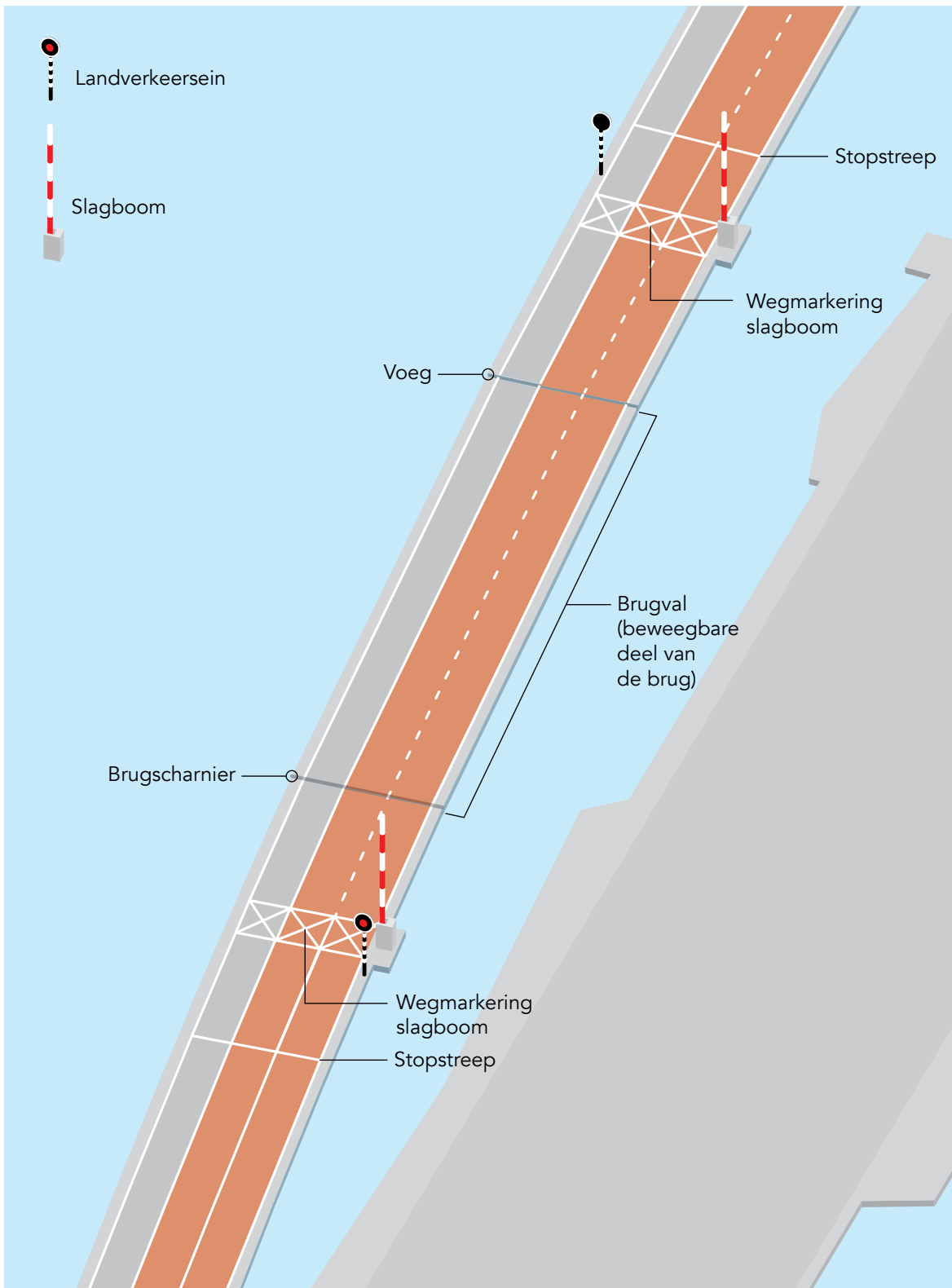
Figuur 4: Inrichting van de fietsbrug.
