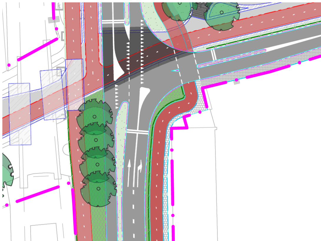
Figuur 5-8: Indeling nabij Olam Cocoa, met gescheiden functies en versmalde middenberm
